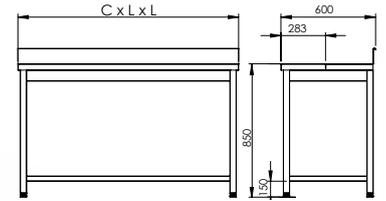
600 | Tampo ½ inox + ½ polietileno | Plateau ½Inox½Polyethylene | Top ½ inox + ½ polyethylene
