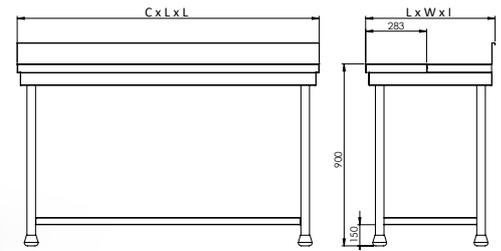
600 Tampo ½ inox + ½ polietileno | Plateau ½Inox½Polyethylene | Top ½ inox + ½ polyethylene
