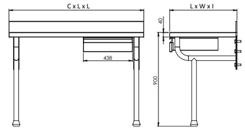
Mesa suspensa por medida | Custom-made suspended table | Table suspendue sur mesure
